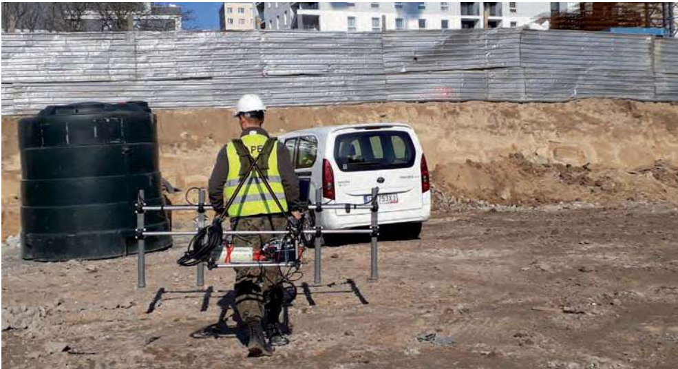
Rys. 4.2. Rozpoznanie podłoża pod kątem występowania przedmiotów niebezpiecznych i niewybuchów pochodzenia militarnego
